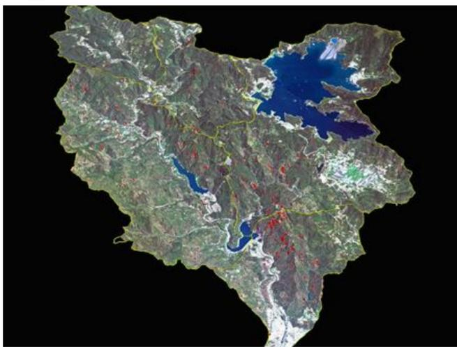
圖 1. 南投縣水里溪集水區(面積8,362公頃) 2015.04.14 法國 Pléiades 衛星全色融銳化融合影像，空間解析度50cm。結合數值地形模型(DTM)展示立體透視圖。應用影像分割技術萃取的紅色多邊形，代表坡度大於15度、面積大於0.04公頃的崩塌地及土壤裸露區塊。
