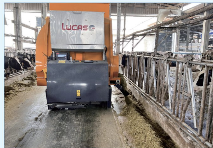
圖BOX4.4.2.1 自動餵飼系統及電動餐車送料 (資料來源：農業部畜產試驗所)
