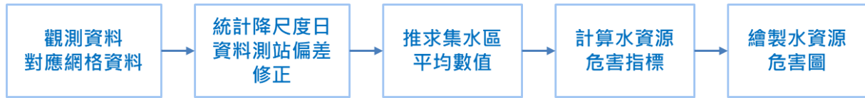
圖 1、 AR5 水資源危害圖產製流程圖
