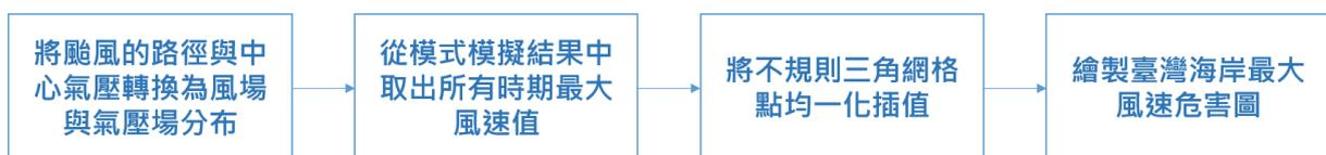
圖 2、AR5 海岸危害圖資產製流程圖
