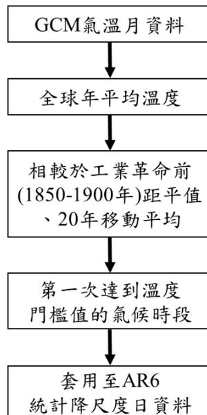
圖 7、AR6 統計降尺度全球暖化程度(GWLs)資料產製流程圖
