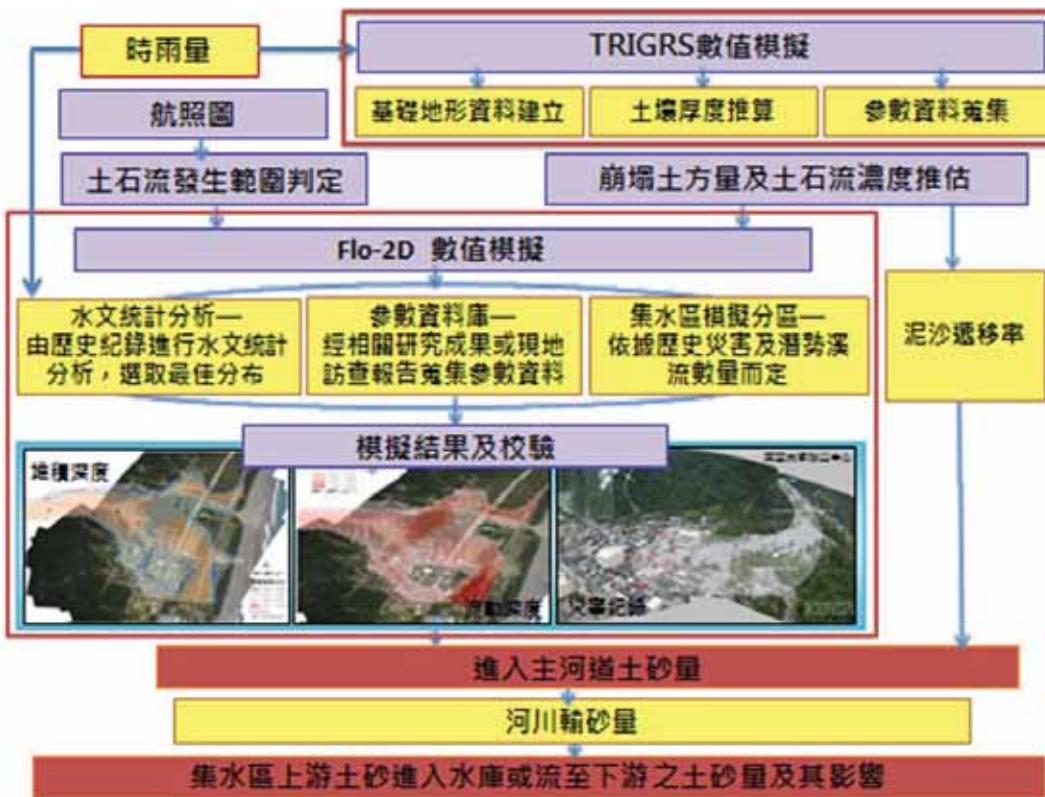
圖 4.8 土砂災害資料串接研究流程圖
