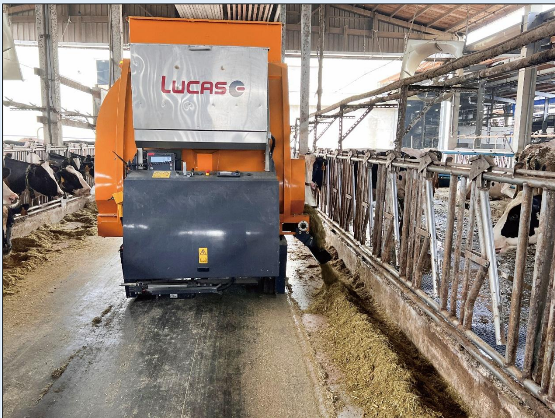
圖 BOX4.4.2.1 自動餵飼系統及電動餐車送料
